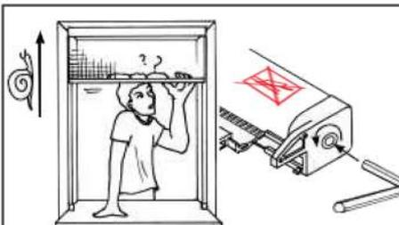
**FR** | La toile ne remonte plus : Le ressort nécessite d'être retendu à l'aide d'une clé Allen - 6 pans (non fournie), 12 à 15 tours dans le sens de la tension.
