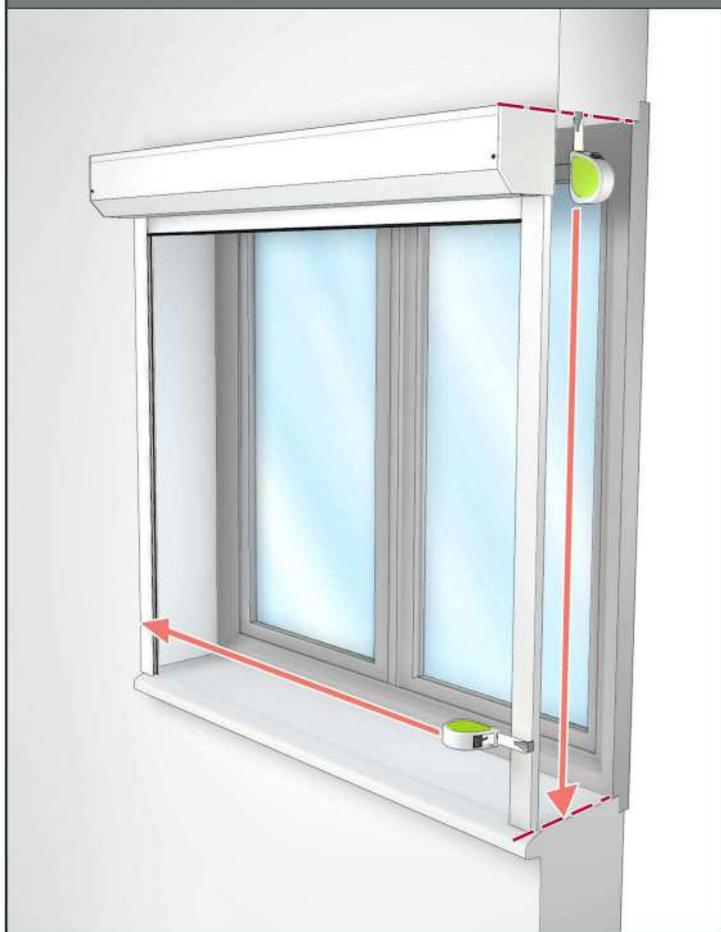
**4** Mida las dimensiones **X** y **Y** de la salida del cable del cajón de la persiana enrollable y transfíralas al marco de la ventana.. **X** y **Y** deben tener 3cm como mínimo.
