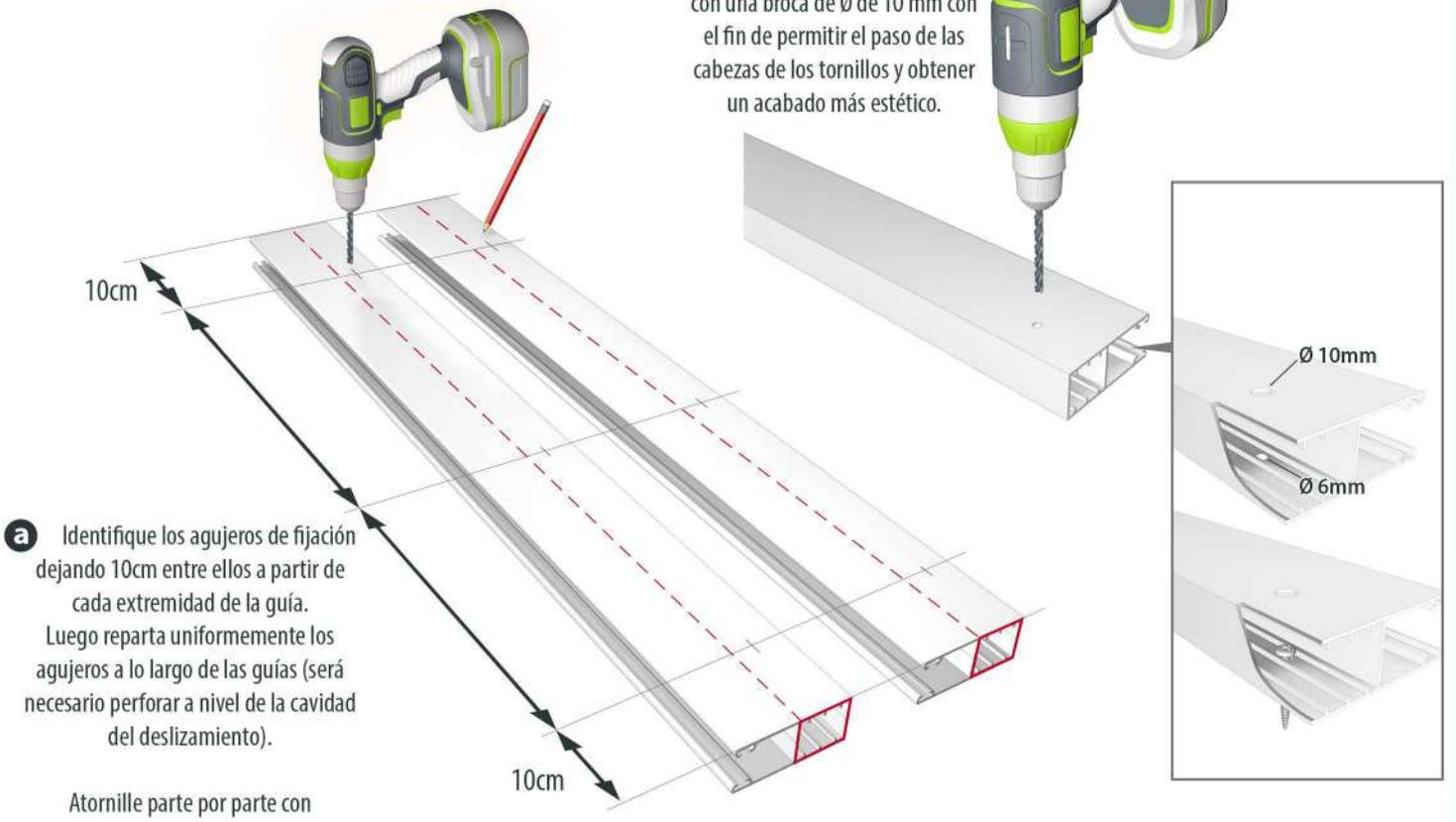
**a** Identifique los agujeros de fijación dejando 10cm entre ellos a partir de cada extremidad de la guía. Luego reparta uniformemente los agujeros a lo largo de las guías (será necesario perforar a nivel de la cavidad del deslizamiento).
