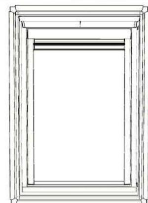
**FR** Détacher le lien de la ficelle grise droite, puis l'attacher sur le bas de la glissière droite. Placer ensuite le store dans le haut de la glissière droite en faisant attention à ce qu'il soit bien droit dedans. Finir de positionner la glissière en la passant sous le tablier du store en haut, et reposer sur la fenêtre en bas. Faire de même pour le côté gauche.
