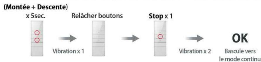
• En mode pas à pas, presser le bouton haut ou bas pendant 2 secondes, le moteur commencera alors à fonctionner pas à pas. Si l'appui dure plus de 2 secondes, alors le moteur va fonctionner en continu.
